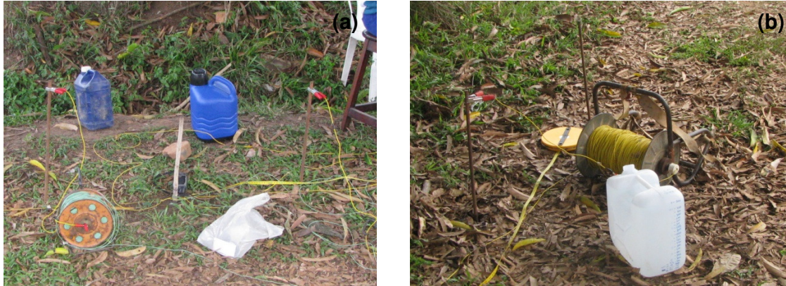
FOTOGRAFIA 7.2 – Em (a) Disposição do eletrodo na superfície. Em (b) Solução de água salgada para umedecer o solo.
