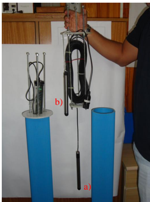
Foto1 – Aparelho Dipperlog. a) Unidade submersa (Dipperlog) e b) Unidade emersa (Barlog).
