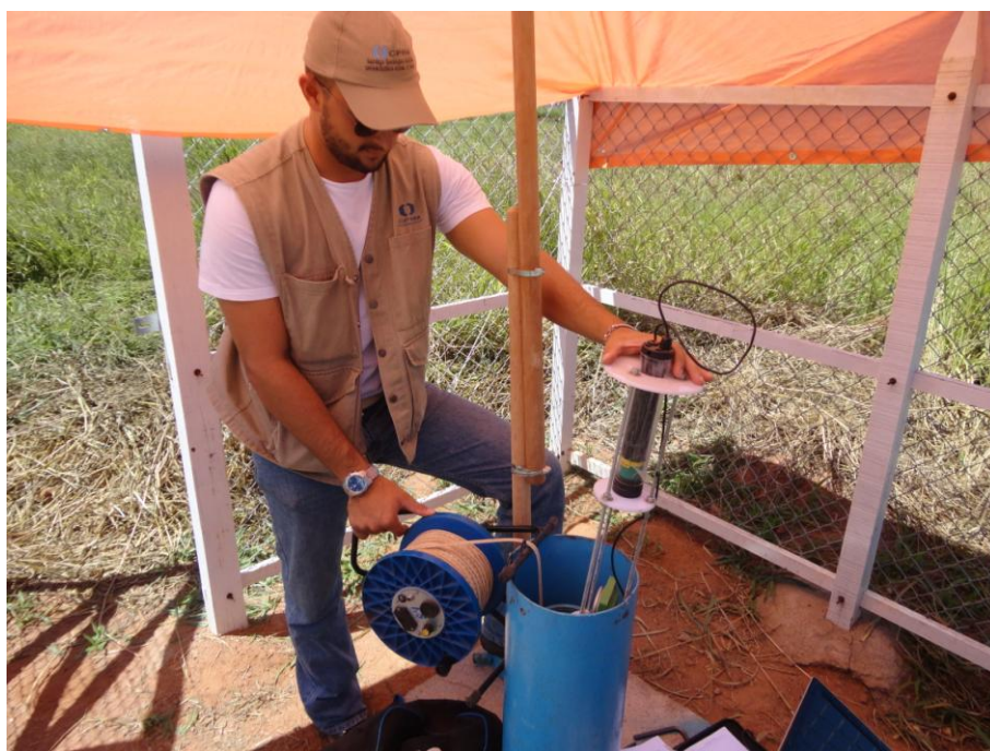
Foto 12- Utilização de medidor manual de Nivel.Ponto PM-24.
