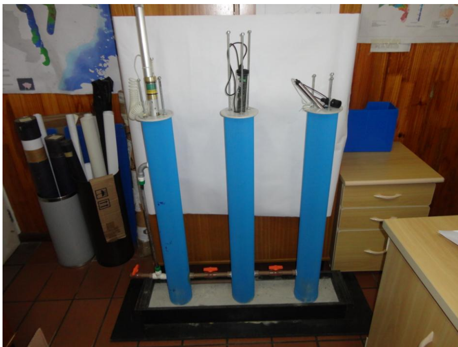
Foto 10 - Protótipo dos poços com os Dataloggers instalados.
