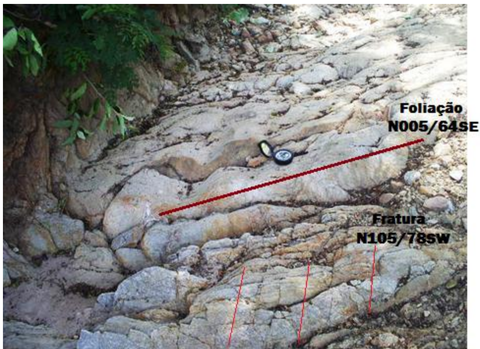
Foto 1 - Afloramento de Gnaiss Granítico, foliado (N005/64SE) e fraturado (N105/78SW). Foto em planta, com bússola apontando para o norte. Coordenadas S 13°03'24"; W042° 39' 01,3".
