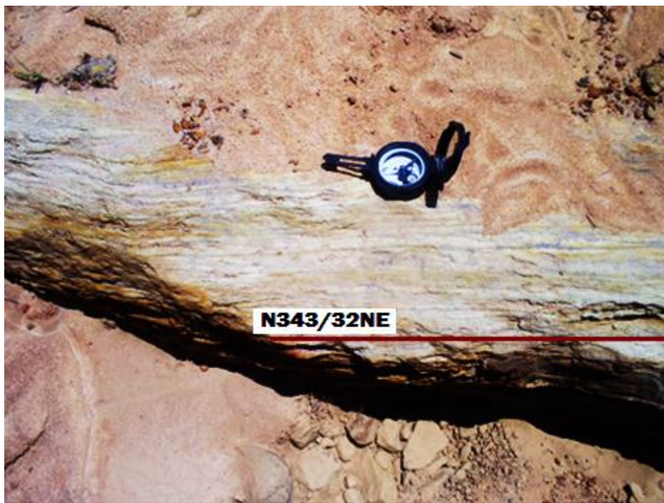
Foto 7 - Afloramento mostrando foliação (N343p/32) nos xisto. Foto em planta com a bússola apontando para o Norte, Coordenadas S 13°05'01,4"; W042° 41' 04,2".
