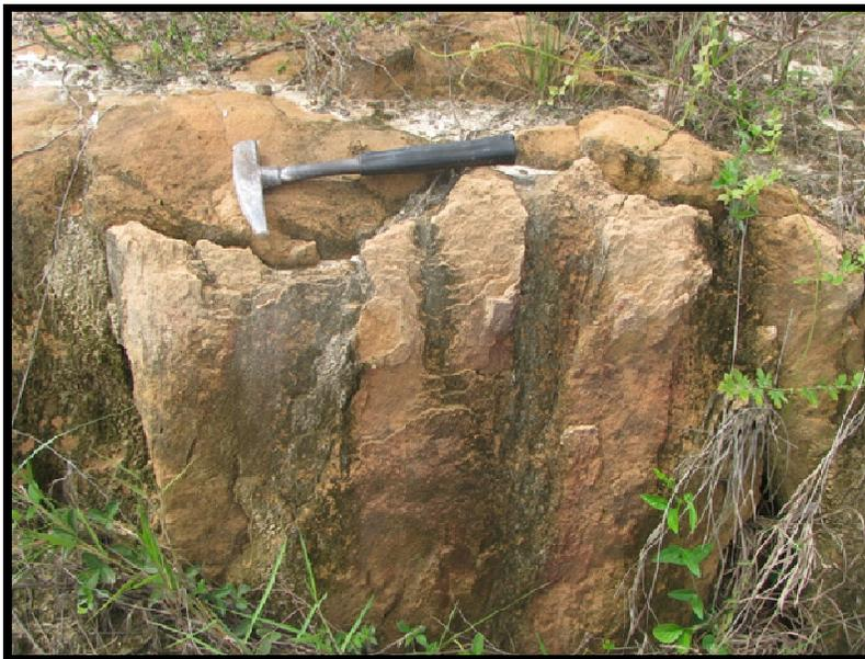
FOTO 11 - Plano de cisalhamento sub-vertical no ponto F1 da Figura 12.
