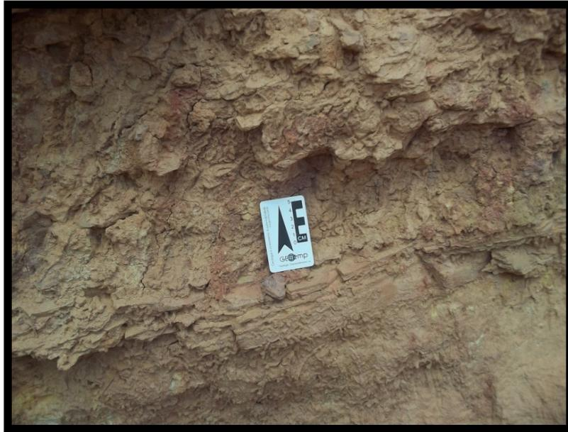
FOTO 10. Estratos com direção e mergulho N120/09SW. Coordenadas do ponto: W586229/S8605817.
