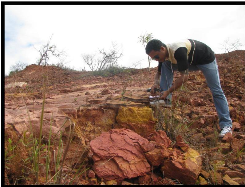
FOTO 04 - Nível laterítico com direção e mergulho N110°/10°SW na Formação São Sebastião. Coordenadas do ponto: W585805/S8603437.
